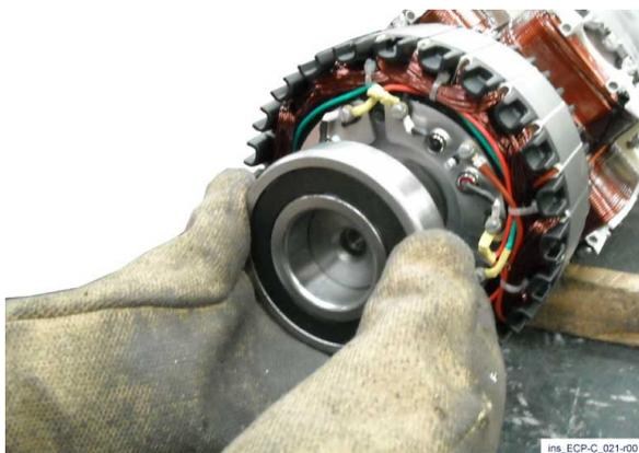
4) À l'aide de gants anti-brûlure appropriés, insérez le palier jusqu'à l'épaule de l'arbre.
