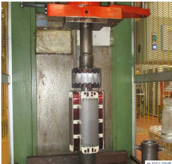
2) À l'aide d'une presse, insérez un nouveau rotor d'excitateur. Alternativement, il est possible de le chauffer à 110°C et de le pousser jusqu'en butée. Passez ensuite les câbles du rotor principal dans le trou du rotor de l'excitatrice, puis fixez-les au pont de diodes en respectant la bonne polarité.
