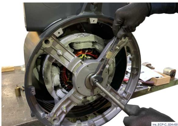
7) Vissez une tige filetée dans le trou arrière de l'arbre et vissez un écrou à l'autre extrémité, en plaçant une bride de taille appropriée entre l'écrou et le couvercle arrière. Visser ensuite l'écrou jusqu'à ce que le roulement d'arbre entre en contact avec son siège dans le couvercle arrière.
