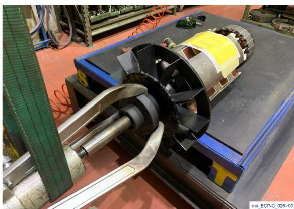
1) Retirez le volant du moyeu, montez un extracteur hydraulique ou pneumatique approprié et mettez-le sous pression.
