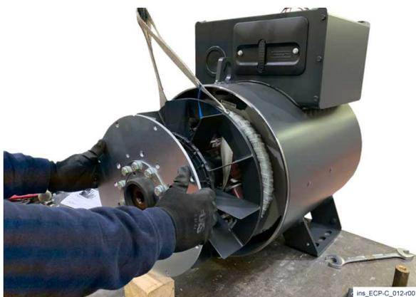
7) Extrayez le rotor en le tirant à la main. Pendant cette opération, placez des blocs de bois sous les disques, afin de soutenir le rotor.
