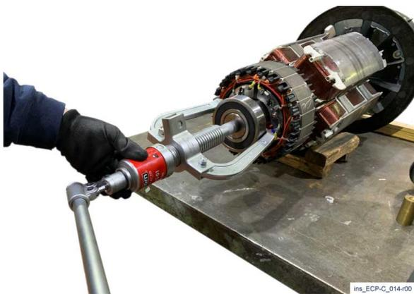
9) À l'aide d'un extracteur approprié, retirez le palier de l'arbre. Retirez le rotor de l'excitatrice à l'aide d'un extracteur à bras.
