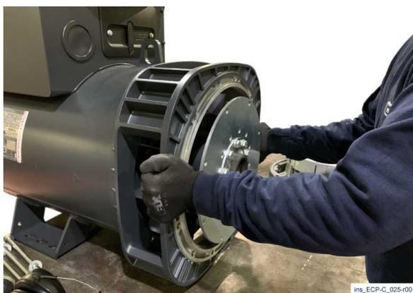
8) Remettez le capot avant. Faites correspondre les repères effectués précédemment entre le couvercle et le carter, puis revissez les tirants. Rebranchez les fils jaune et bleu au régulateur, puis fixez-les avec des attaches de câble. Enfin, remontez la grille arrière et le couvercle de la boîte à bornes.
